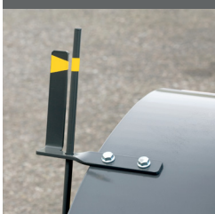
Høydeindikator Visuelt hjelpemiddel for å holde optimalt og jevnt marktrykk.
