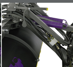
Avbalansering Unik løsning hvor børstevalsen har jevnt trykk mot underlaget.
